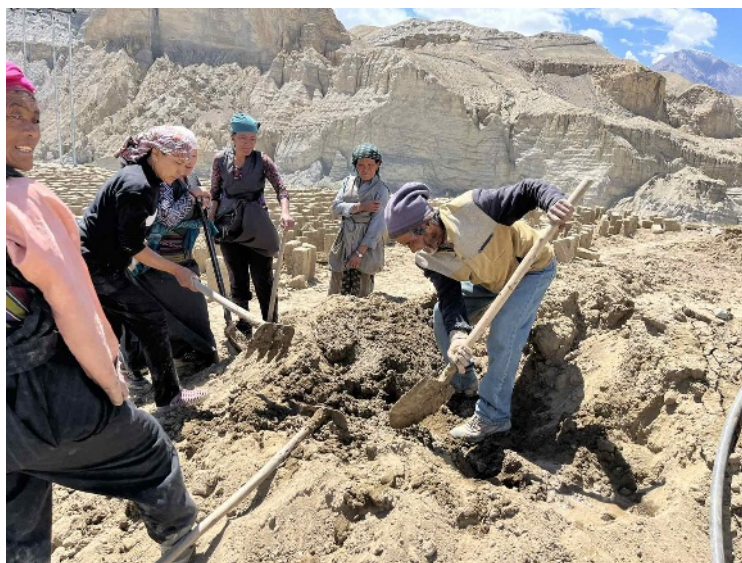
Préparation de l'argile pour mouler des briques.
