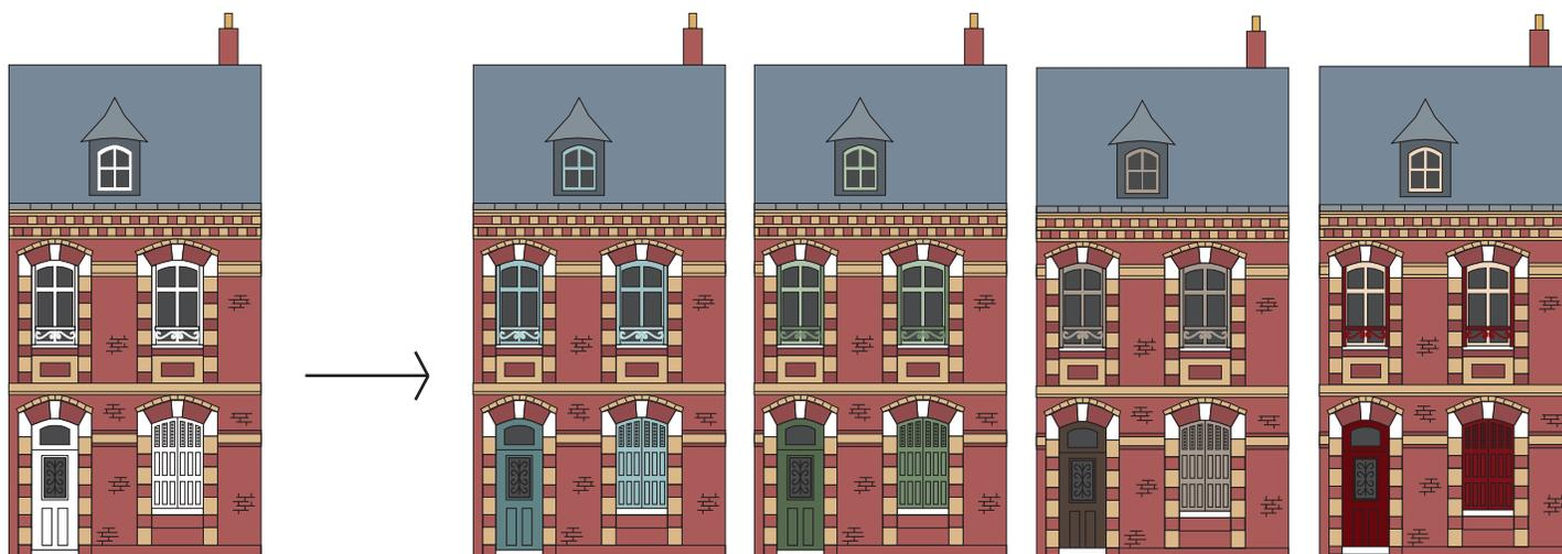
Les maçonneries en brique alternent souvent brique jaune et brique rouge. Elles doivent rester apparentes et on tiendra compte de leurs nuances pour choisir les couleurs des menuiseries.
